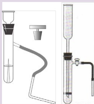
Рис. 7. Прибор для получения и собирания газов
