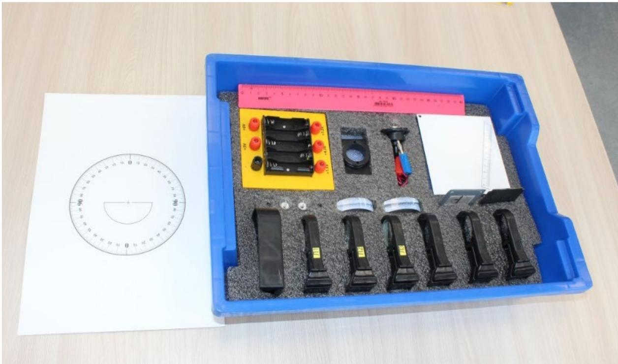
**Рис. 1.** Оборудование комплекта для проведения экспериментов по оптике
